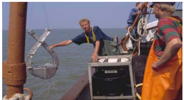
Abbildung: Probennahme mit Van Veen Greifer
